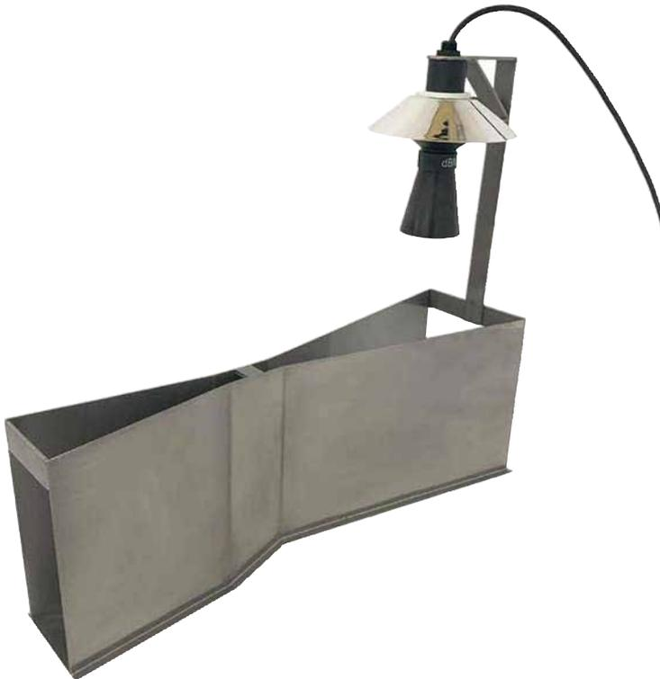
Canal abierto para la medición del caudal de entrada en las plantas de depuración. La medición del caudal se realiza mediante un medidor de nivel por ultrasonido y un equipo de conversión para volúmenes.
