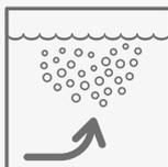
**Aireación:** Mediante el aire introducido por una bomba soplante se produce la degradación biológica de la materia orgánica y la nitrificación.
